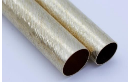
Správně obroušený povrch pro lepení
