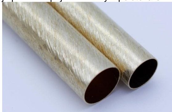
Správně obroušený povrch pro lepení
