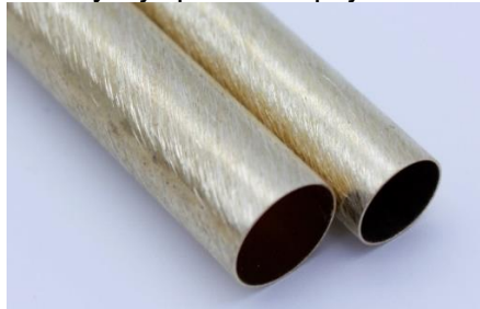
Správně obroušený povrch pro lepení
