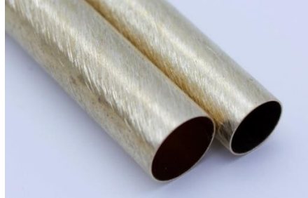
Správně obroušený povrch pro lepení
