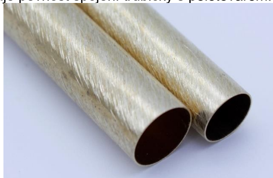
Správně obroušený povrch pro lepení
