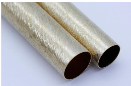
Správně obroušený povrch pro lepení
