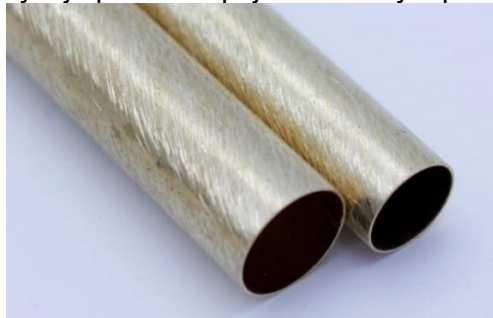
Správně obroušený povrch pro lepení
