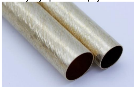
Správně obroušený povrch pro lepení
