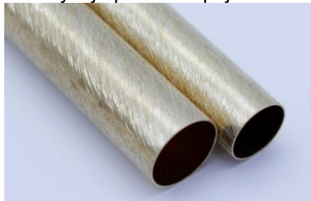
Správně obroušený povrch pro lepení
