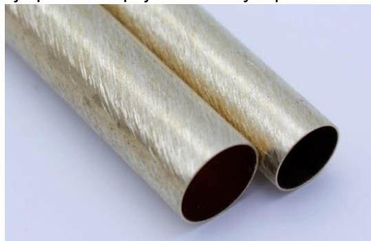
Správně obroušený povrch pro lepení
