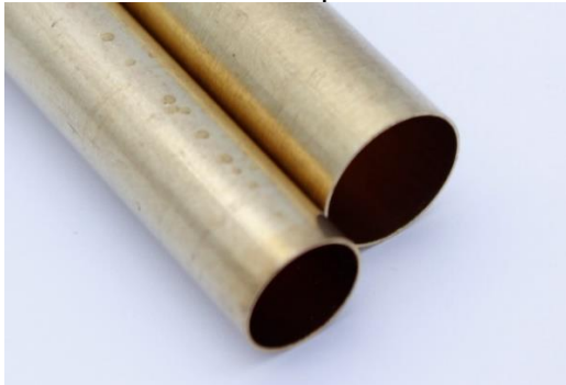
Povrch bez broušení
