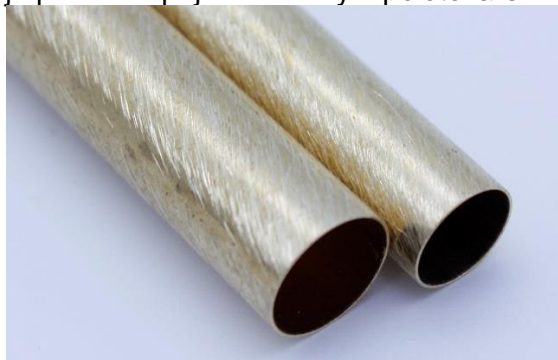
Správně obroušený povrch pro lepení
