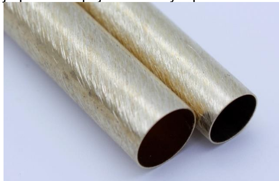
Správně obroušený povrch pro lepení
