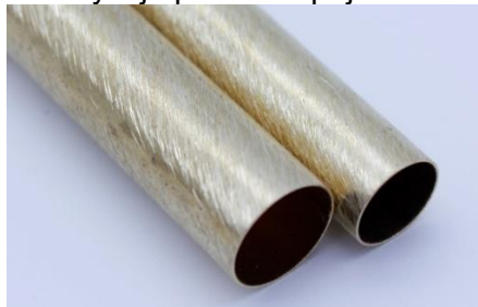
Správně obroušený povrch pro lepení
