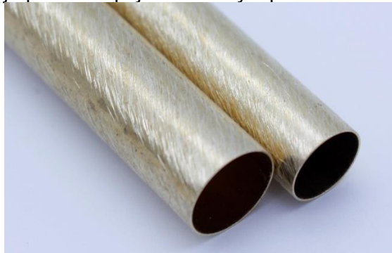
Správně obroušený povrch pro lepení
