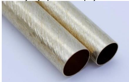
Správně obroušený povrch pro lepení
