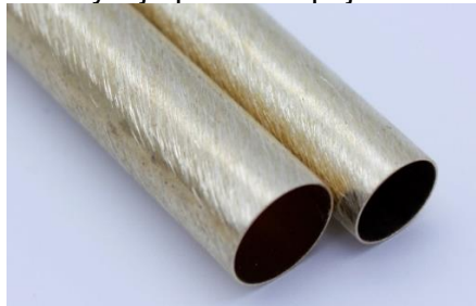
Správně obroušený povrch pro lepení
