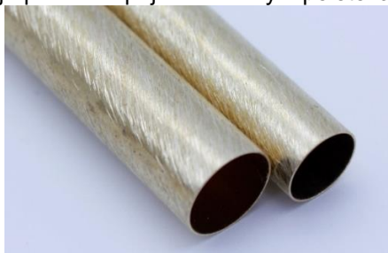
Správně obroušený povrch pro lepení
