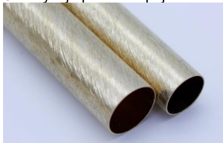
Správně obroušený povrch pro lepení
