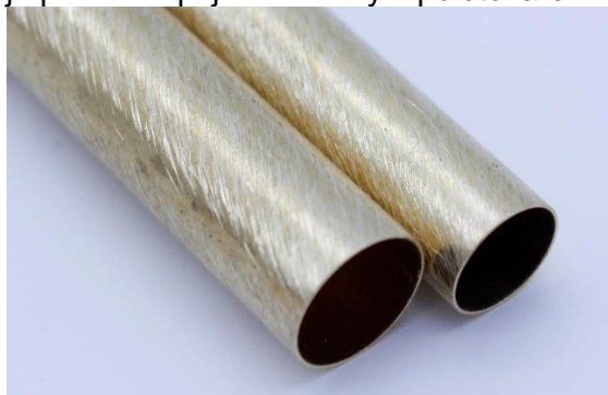
Správně obroušený povrch pro lepení
