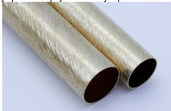
Správně obroušený povrch pro lepení
